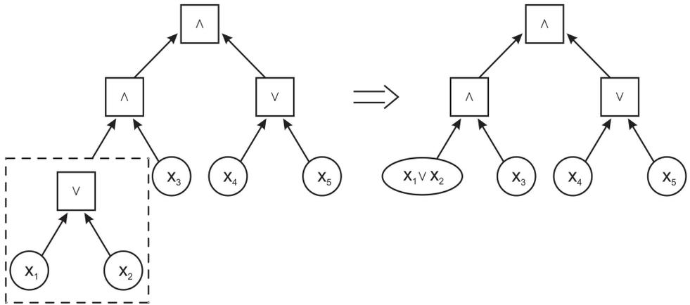
Рис. 2. Ориентированные деревья, изображающие последовательность операций вычисления надежности  $P(A(x_1, \dots, x_n) = 1)$ .
