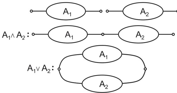
Рис. 3. Двухполюсники, изображающие булевы функции  $A_1$ ,  $A_2$ ,  $A_1 \wedge A_2$ ,  $A_1 \vee A_2$ .
